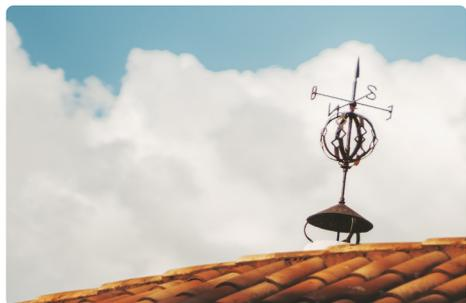
L'enseignant explique alors qu'il existe un instrument qui indique la direction du vent : la girouette. Il présente l'objet aux élèves et explique son fonctionnement : la girouette est équipée d'une flèche, la pointe montre d'où provient le vent<sup>2</sup>.
